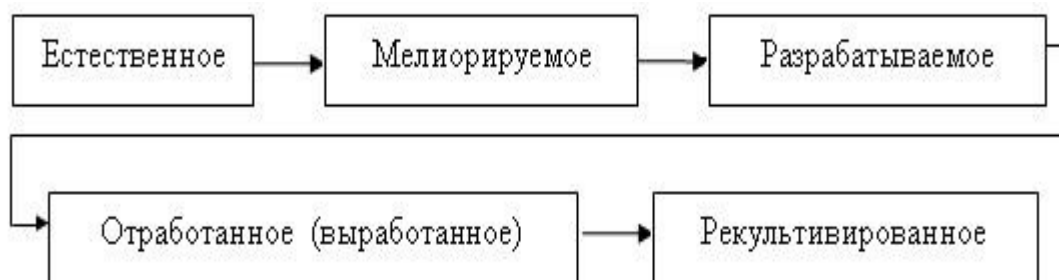
Рис. 137. Стадии эксплуатации торфяного месторождения
