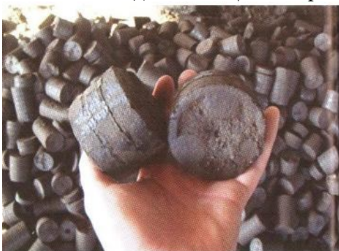
Рис. 147. Высококачественный топливный брикет из торфа
