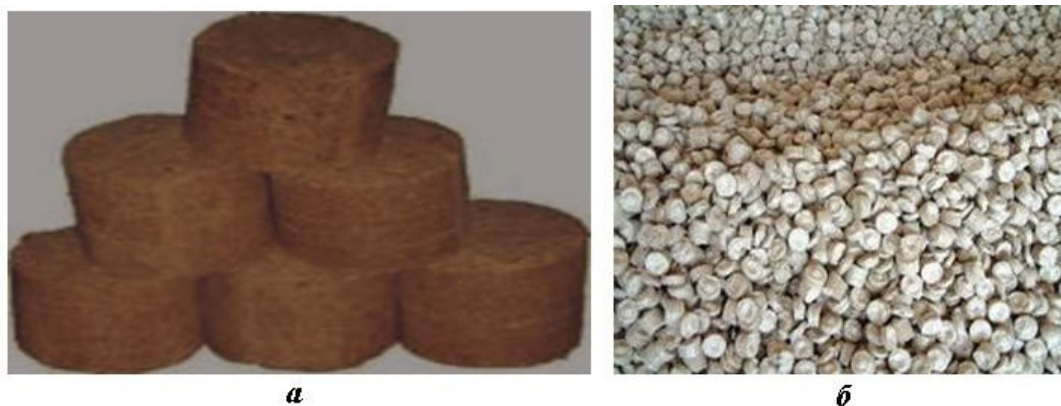
Рис. 134. Топливо: торфяные брикеты (а), торфяные шайбы (б)
