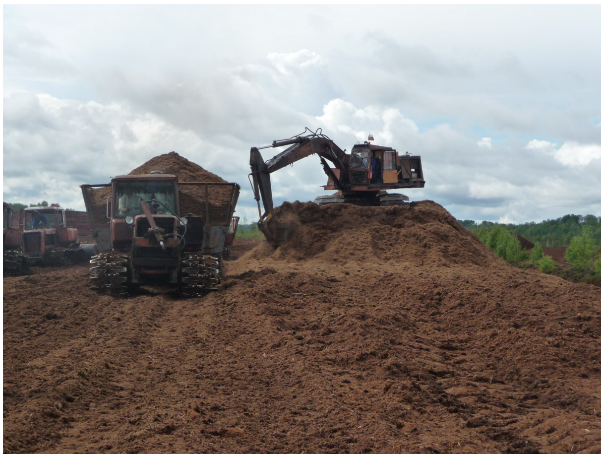
Рис. 130. Погрузка торфа в уборочный транспорт
