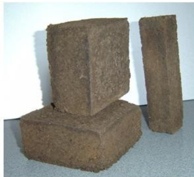
Рис. 148. Торфяные плиты для строительства
