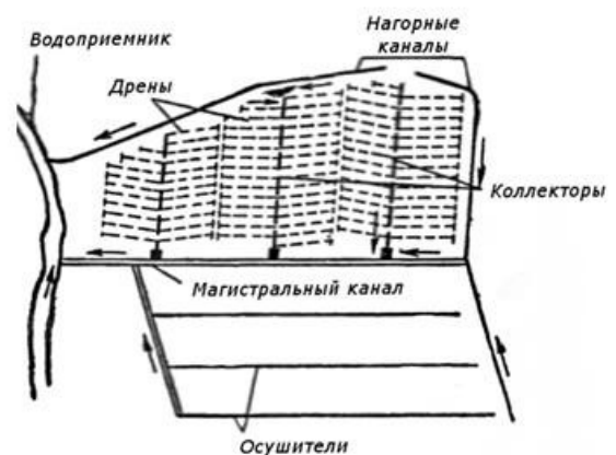
Рис. 116. Схема осушительной системы, состоящей из закрытого дренажа и открытых каналов
