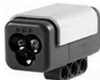
Рис. 1. Цветовой сенсор LEGO-робота
