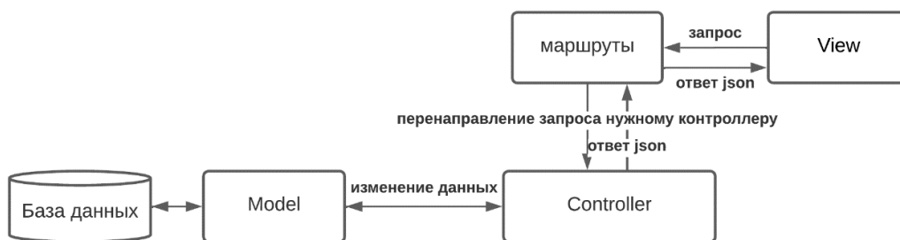
Рис. 3. Схема реализации архитектурного паттерна MVC
