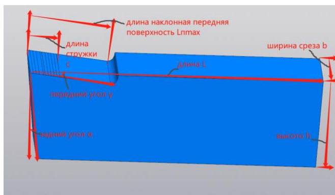
Рис. 4. Геометрические параметры 3Д модели режущей клина: ширина b = 2,82 мм, толщина h = 6 мм, длина L = 18 мм, \lambda = 0^\circ , \gamma = +7^\circ , \alpha = 8^\circ
