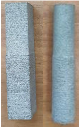
Рис. 4. Высокая шероховатость нижней части объектов из установки селективного лазерного спекания (порошковая АТ) – следствие разных режимов синтеза
