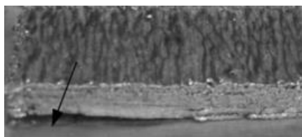
Рис. 2. Деформация объекта из установки электронно-лучевого сплавления (порошковая АТ) [1]
