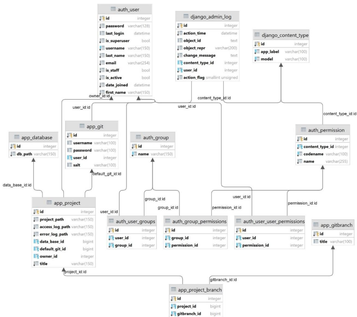
Рис. 1. Реляционная схема базы данных
