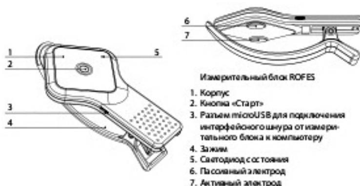
*Рис. 1. Измерительный блок ROFES E01C*
