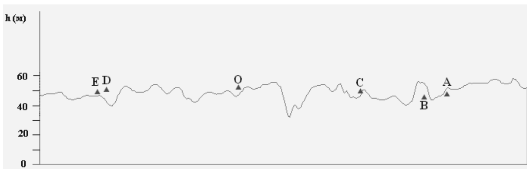
Рис. 4. Профиль рельефа участка трубопровода с обозначенными точками разливов нефти (см. рис. 2)
