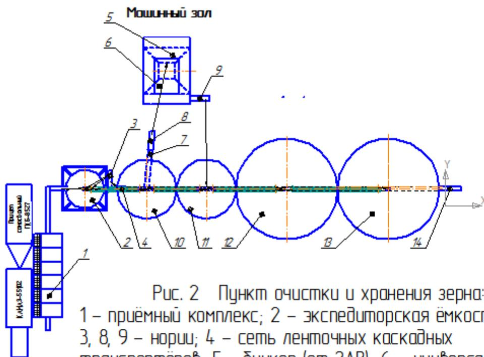
Рис. 2 Пункт очистки и хранения зерна:
