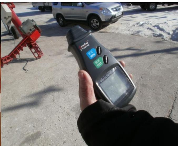
Рис.3. Электронный тахометр
