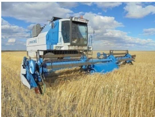
Рис. 1. Хедер с очесывающим адаптером для формирования стерневых кулис с зерноуборочным комбайном «Енисей КЗС-950» в работе
