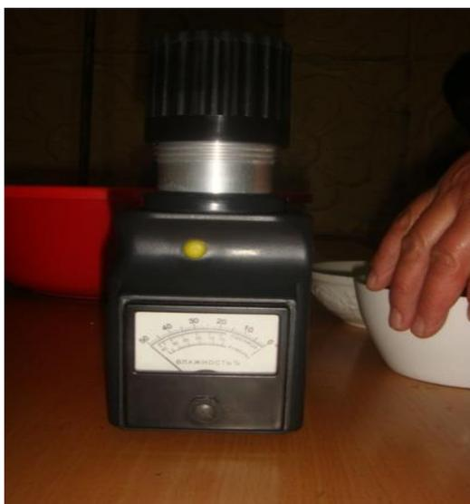
Рис.2. Прибор для определения влажности зерна (FKAGILE)
