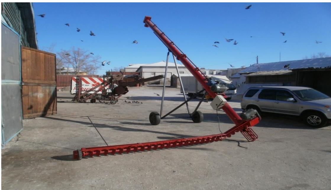
Рис.1. Новый образец шнекового погрузчика
