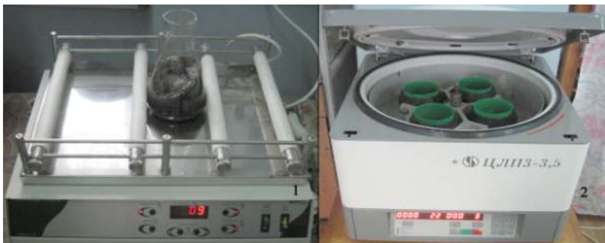
Рис. 12. Оборудование для определения выхода гуминовых кислот: 1 - аппарат для механического встряхивания (встряхиватель); 2 - центрифуга лабораторная.
