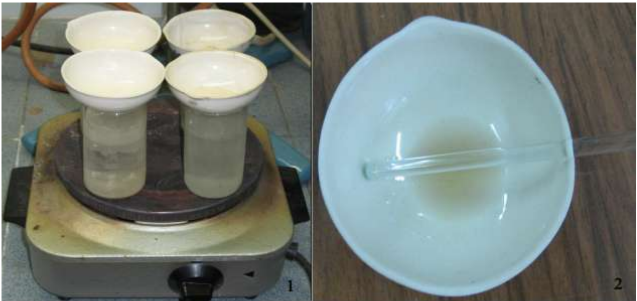
Рис. 7. Определение содержания нитратного азота в торфе: 1 – выпаривание вытяжки на водяной бане; 2 – растирание сухого остатка с фенолдисульфокислотой.
