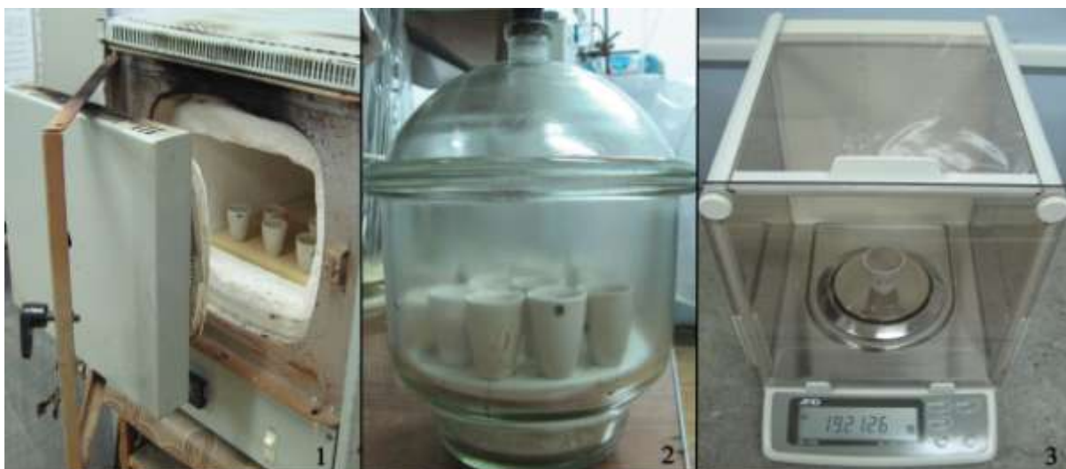
Рис. 3. Оборудование для определения зольности торфа: 1 – муфельная печь; 2 – эксикатор; 3 – аналитические весы.
