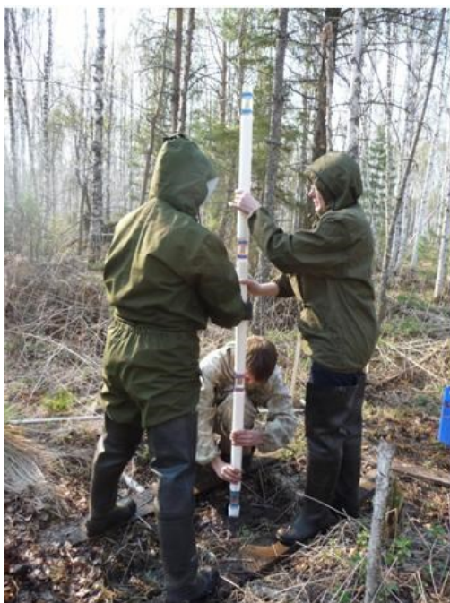
Рис. 86. Установка в торфяную залежь системы для изучения газового режима
