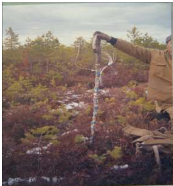
Рис. 17. Прибор для измерения сопротивления Мультиметр DMM 8902 (а); закладка системы датчиков в залежь (б)
