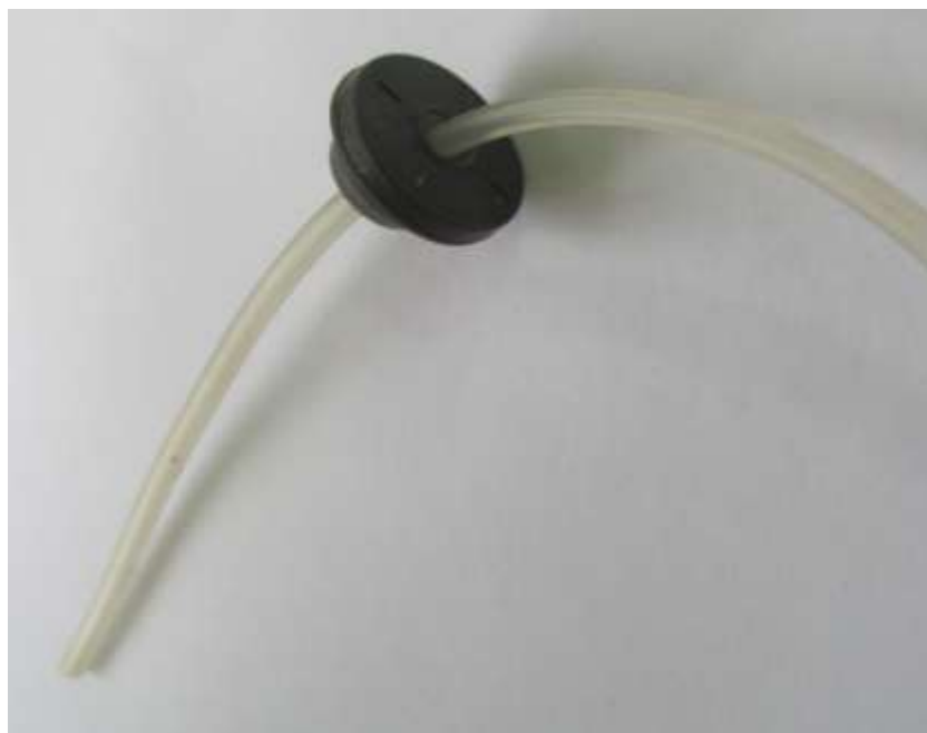
Рис. 33. Силиконовая трубка, продернутая через отверстие в резиновой пробке
