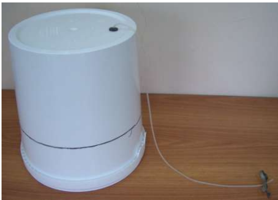
Рис. 34. Собранная конструкция для измерения эмиссии газов
