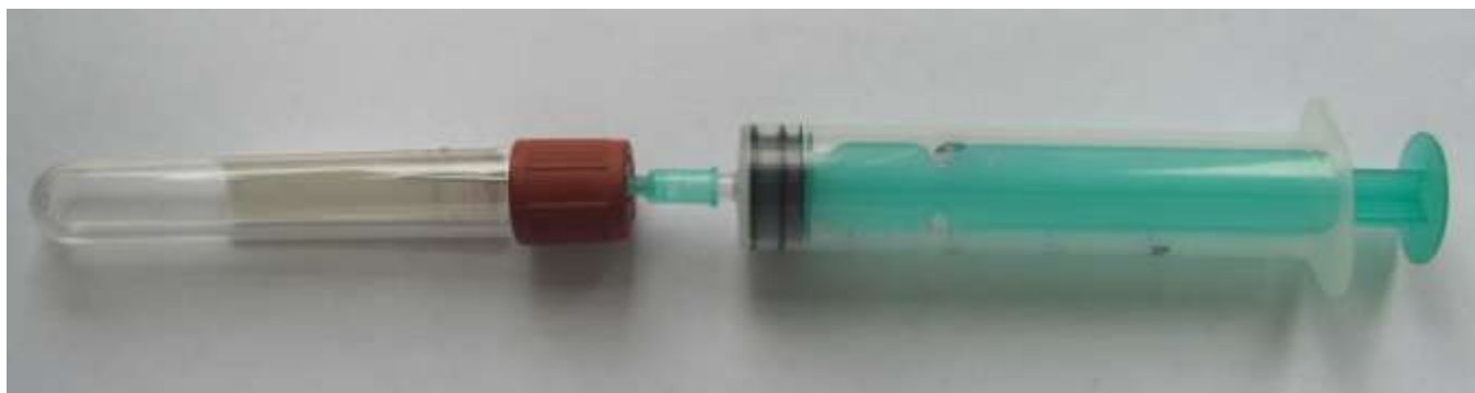
Рис. 31. Введение пробы воздуха в вакутейнер
