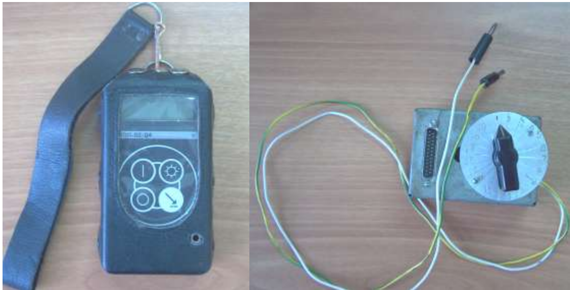
Рис. 21. Электронный измеритель окислительно-восстановительного потенциала ИПП-02/04 (а); прибор переключения между глубинными датчиками (б)
