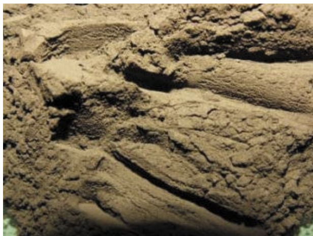
Рис. 1. Фото гидрофобно-модифицирующей торфяной добавки для минеральных дисперсных материалов
